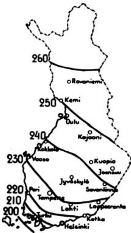
Kuva 15.1. Roudaton syvyys hietamaassa (cm) [D1 2007, kuva 6].
